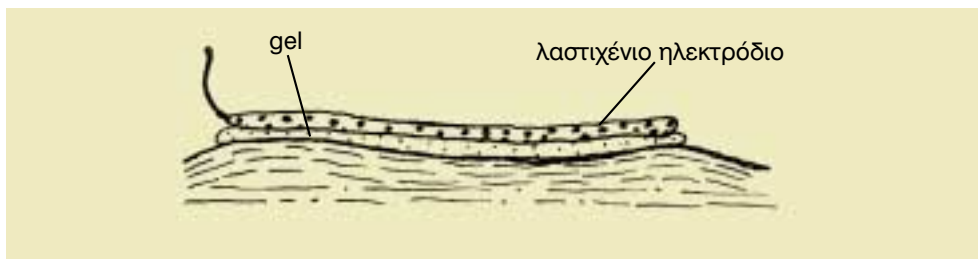
Εικόνα 4.2: Το λαστιχένιο ηλεκτρόδιο είναι εύκαμπτο και προσαρμόζεται καλύτερα επάνω στο δέρμα. Τα κενά ανάμεσα στο ηλεκτρόδιο και την επιδερμίδα τα γεμίζει ειδικό gel.
