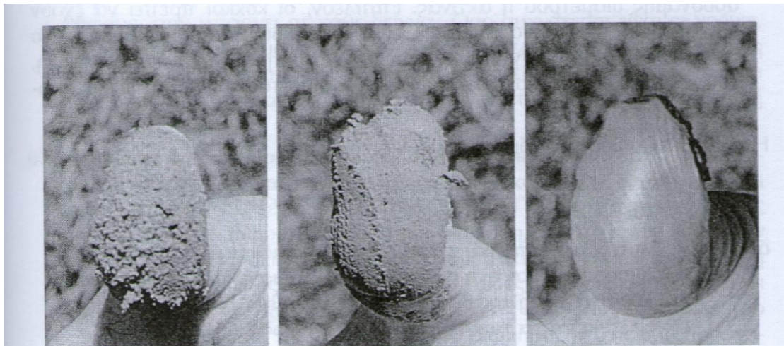
Εικόνα 3.3 Χρήση της μεθόδου "τεστ δακτύλων" για τον προσδιορισμό της μηχανικής σύστασης των εδαφών. Εμφανίζεται η διαφορά στην συνοχή (α) ενός αμμώδους, (β) ενός ιλυώδους και (γ) ενός αργιλώδους εδάφους, όταν αυτά αποκτήσουν την κατάλληλη υγρασία (Brady and Weil, 1996).
