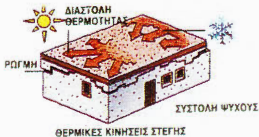
Σχήμα 8.13. Παραδείγματα θερμικών μεταβολών των δομικών στοιχείων.
