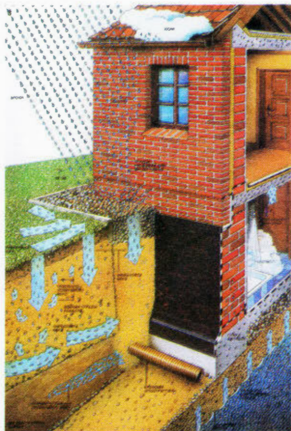
Φωτ. 8.7. Υγρασιακές διαβρώσεις κτιρίου – Υγρομόνωση – Θερμοαχομόνωση.
