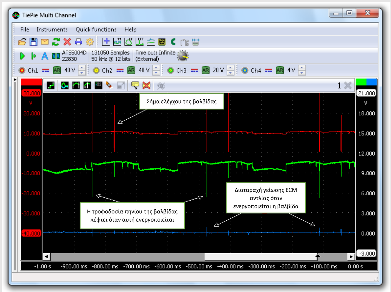
Σχήμα 4: Η τροφοδοσία της βαλβίδας κάνει αιχμές όταν ενεργοποιείται η βαλβίδα
