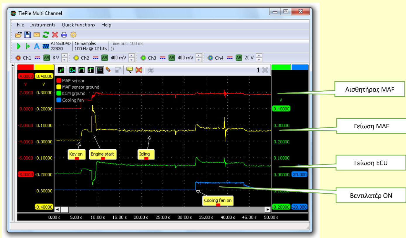
Εικόνα 2: Πτώση τάσης στις συνδέσεις γείωσης
