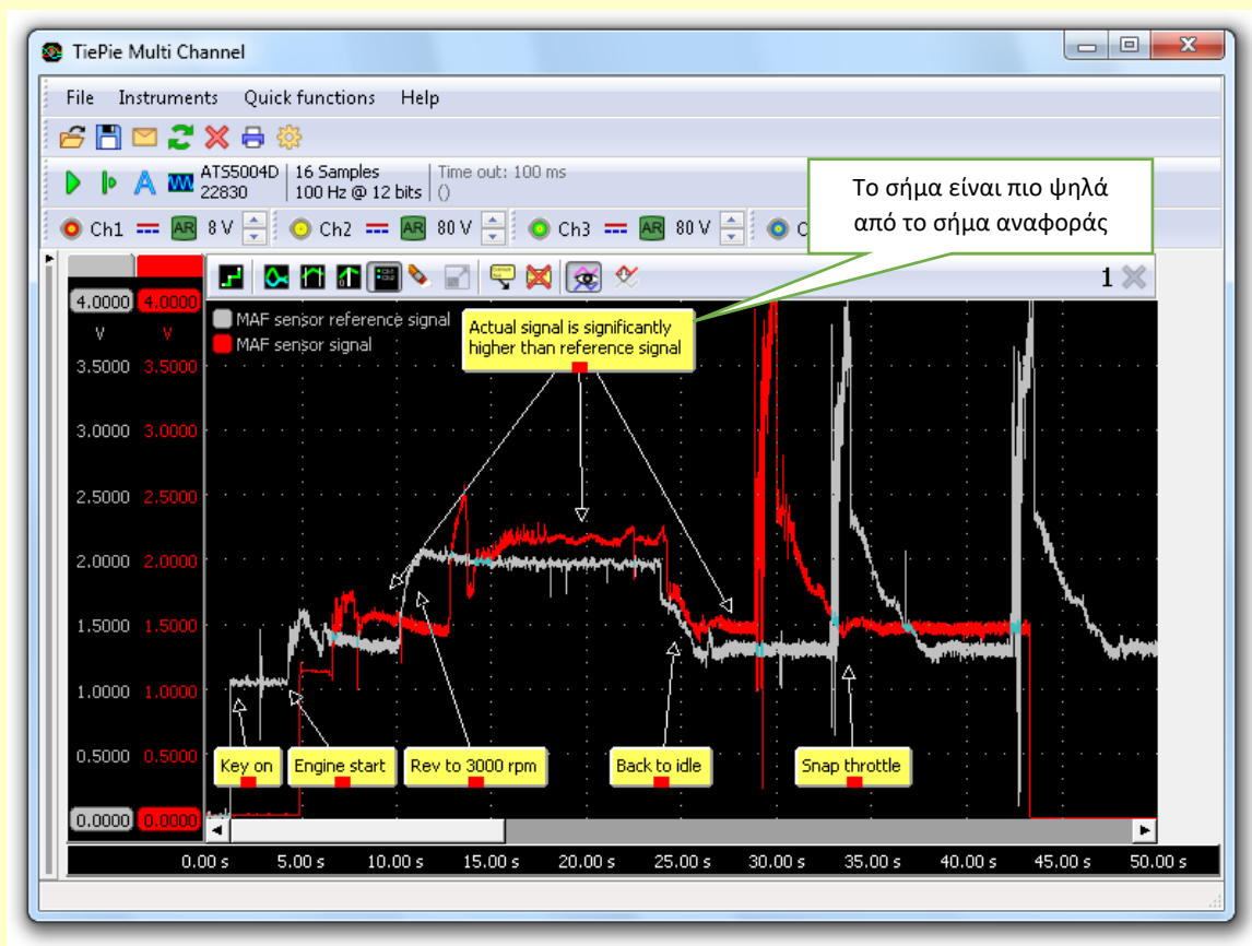
Εικόνα 1: το σήμα MAF είναι πολύ υψηλό
