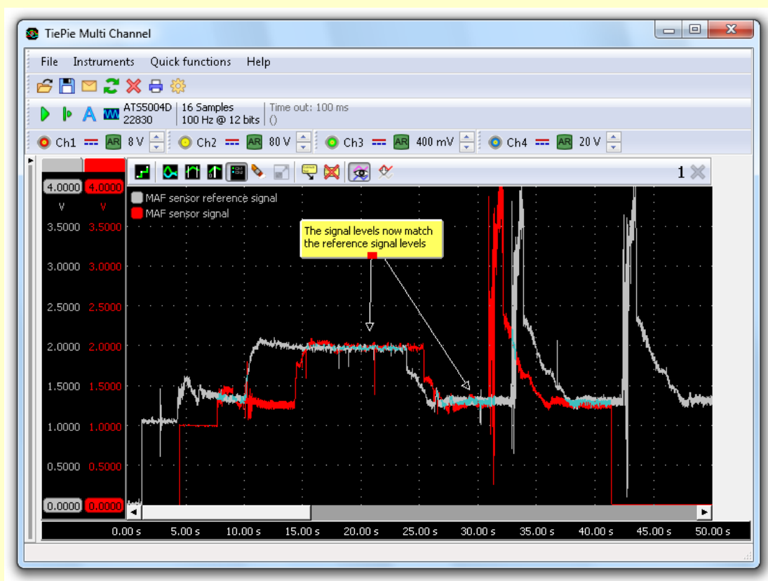
Εικόνα 4: το σήμα MAF είναι τώρα εντάξει
