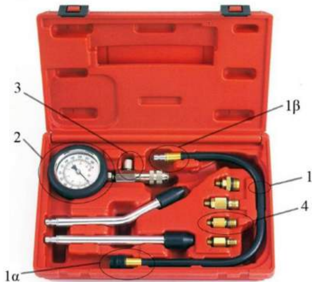
Σχήμα 4.4 Συμπιεσόμετρο βενζινοκινητήρα: 1. Προέκταση συμπιεσόμετρου, 1α. Υποδοχή ομοιώματος σπινθηριστή, 1β. Υποδοχή μανόμετρου, 2. Μανόμετρο, 3. Βαλβίδα εκτόνωσης, 4. Ομοίωμα σπινθηριστή.
