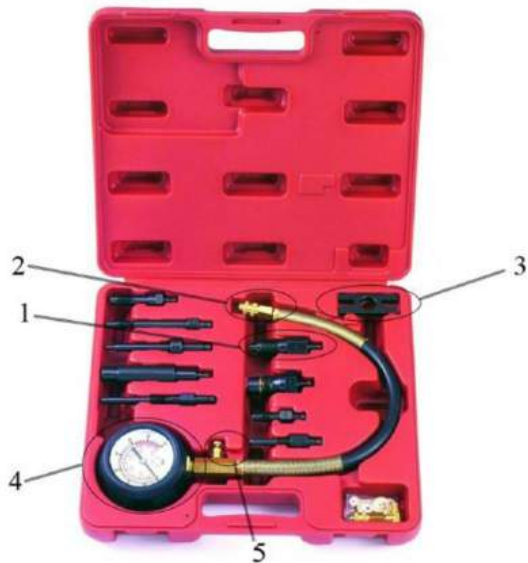
Σχήμα 4.7 Συμπιεσόμετρο πετρελαιοκινητήρα 1: Ομοίωμα εγχυτήρα, 2: Υποδοχή της ομοιώματος εγχυτήρα, 3: Έλασμα σχήματος ήτα με σπή, 4: Πιεσόμετρο(μανόμετρο), 5: Βαλβίδα εκτόνωσης.
