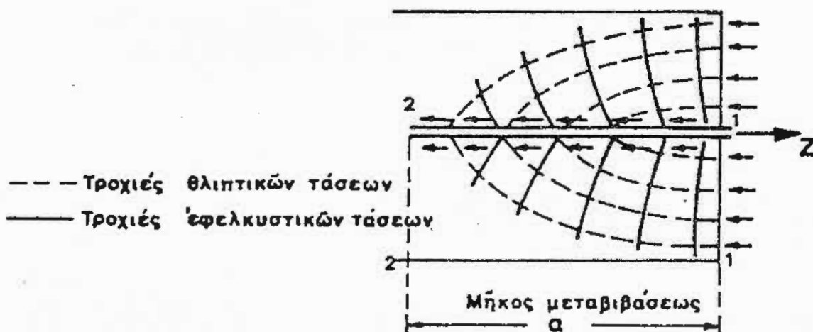
Σχήμα 16.1 Μεταβίβαση δυνάμεων κατά την εξόλκευση ράβδου οπλισμού.
