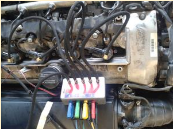
Εικόνα 4: Το RFS 400 συνδέεται στα τέσσερα πρώτα μπεκ με τα τέσσερα καλώδια λήψης του παλμογράφου
