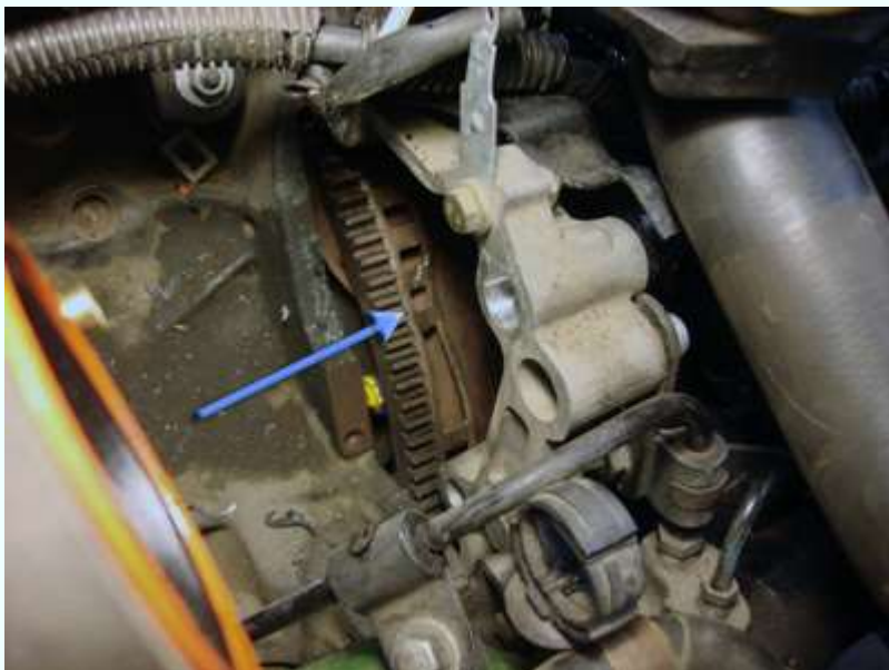
Σχήμα 6: Παραμόρφωση του τροχού σκανδαλισμού πίσω από το γρανάζι του σφονδύλου
