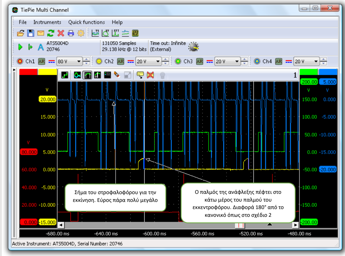
Σχήμα 3: Σήματα στο πάτημα της μίζας και στην εκκίνηση του κινητήρα
