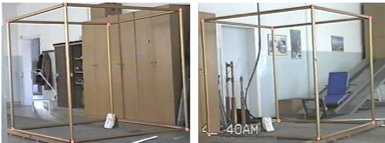
Εικόνα 3. 12: Σημεία βαθμονόμησης πάνω σε ένα τρισδιάστατο πλαίσιο αναφοράς 1.80 X 1.80 X 1.80 m.
