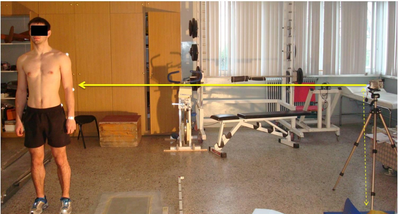
Εικόνα 3.9: Παράδειγμα τοποθέτησης βιντεοκάμερας υψηλής συχνότητας. Η κάμερα τοποθετείται κάθετα προς το επίπεδο μέτρησης και καθορισμένο ύψος, ώστε να γίνεται λήψη ολόκληρου του σώματος.
